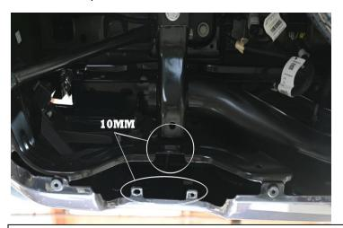
1) FIRST, REMOVE  $\underline{3}$  BOLTS HOLDING BOTH DRIVER AND PASSENGER SIDE FACTORY TIPS ON. THERE IS  $\underline{2}$  LOCATED ON THE INSIDE OF THE BUMPER AND  $\underline{1}$  LOCATED DIRECTLY ABOVE THE TIP.
